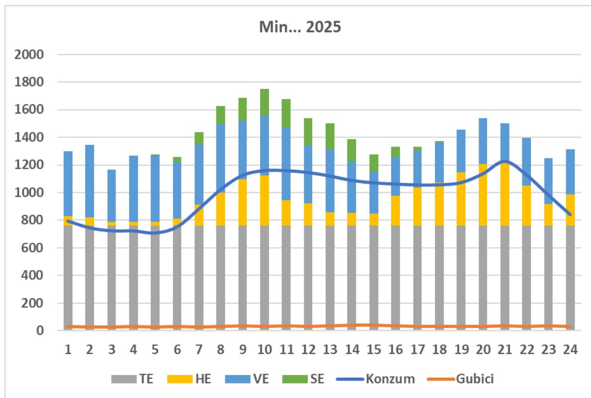
Slika 9.6. Režim minimalnog opterećenja za 2025. godinu (MW)
