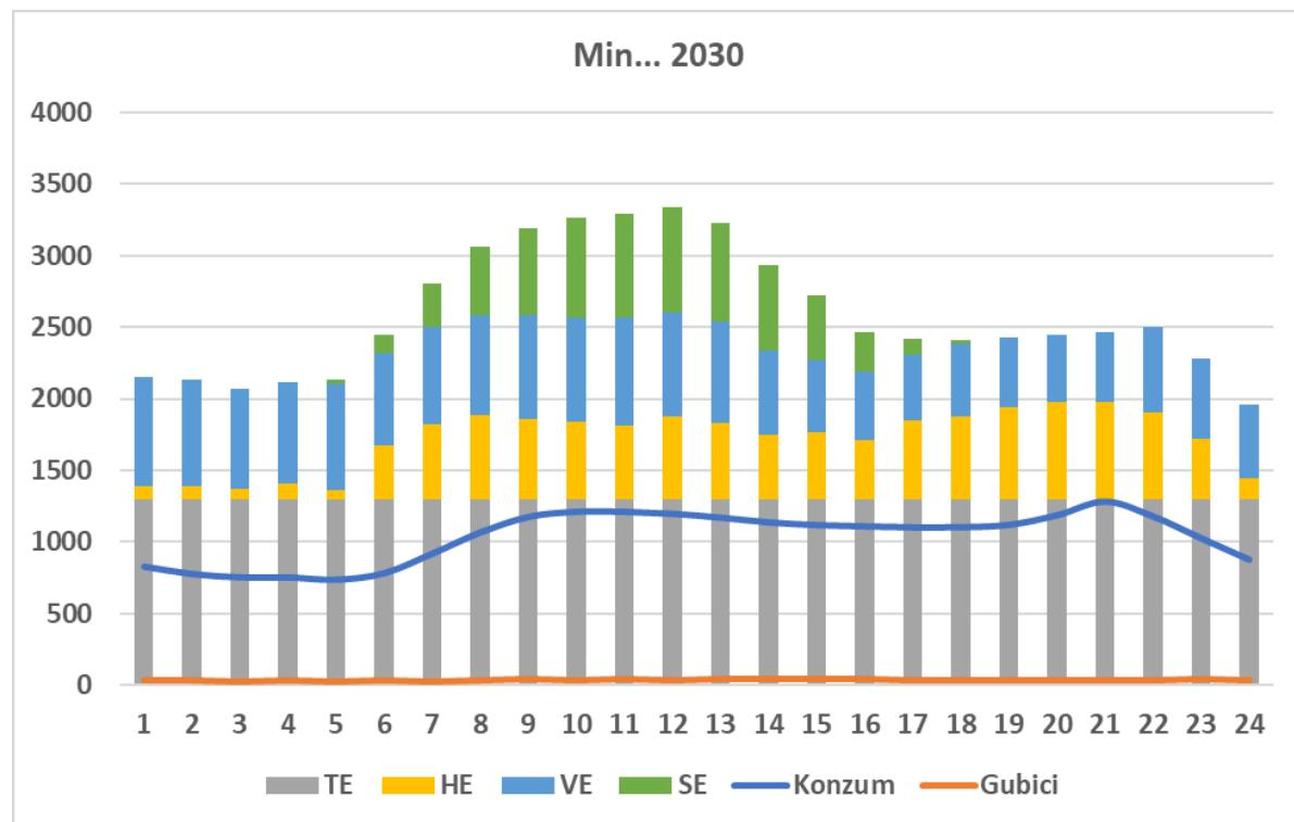
Slika 9.7. Režim minimalnog opterećenja za 2030. godinu (MW)
