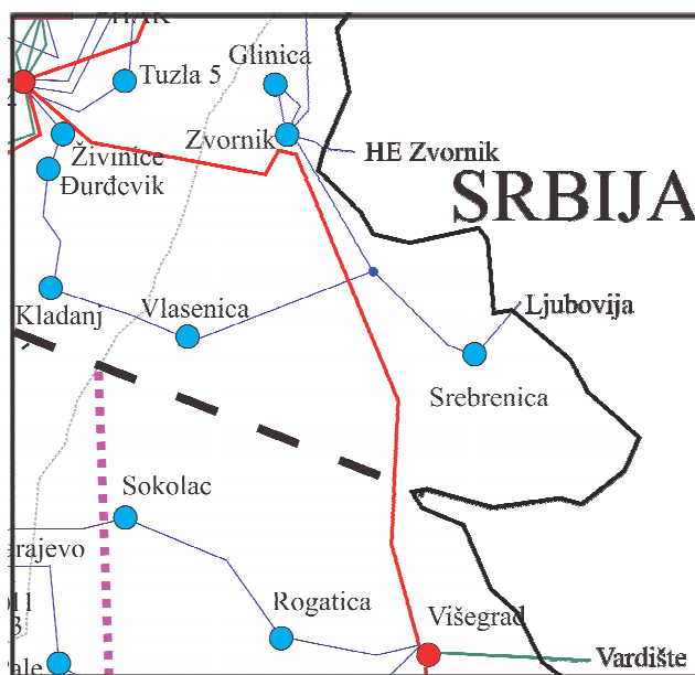
Slika 8.23. Uklopanje DV 110 kV Srebrenica – Ljubovija
