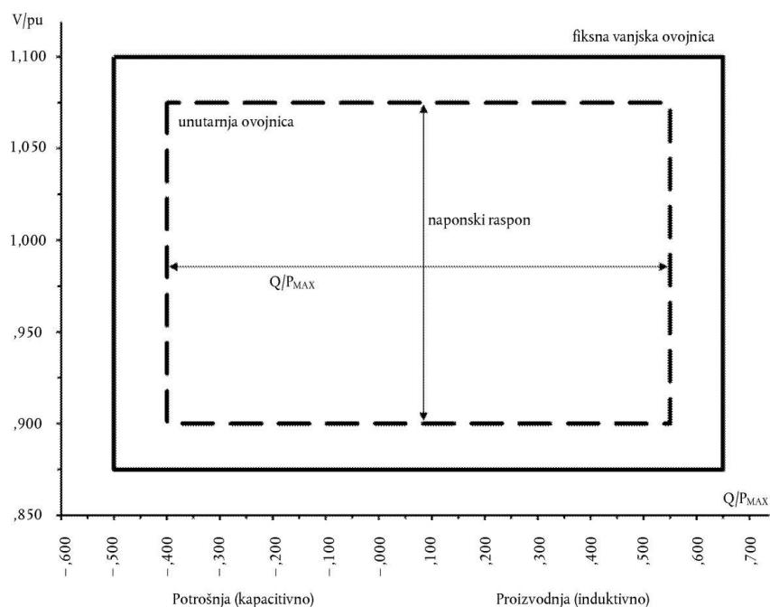
Dijagramom se prikazuju granice karakteristike  $U-Q/P_{max}$  ovisno o odnosu napona na mjestu priključenja, izraženog omjerom njegove stvarne vrijednosti i referentne vrijednosti od 1 pu, i omjera jalove snage ( $Q$ ) i maksimalne snage ( $P_{max}$ ). Položaj, veličina i oblik unutarnje ovojnici su okvirni.
