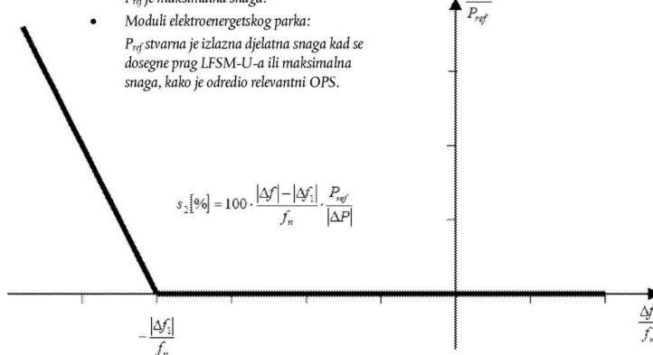
$P_{ref}$  referentna je djelatna snaga na koju se odnosi  $\Delta P$  i može biti različito određena za sinkrone proizvodne module i module elektroenergetskog parka.  $\Delta P$  je promjena izlazne djelatne snage proizvodnog modula.  $f_n$  je nazivna frekvencija (50 Hz) u mreži a  $\Delta f$  frekvencijsko odstupanje u mreži. Na podfrekvencijama pri kojima je  $\Delta f$  ispod  $\Delta f_1$  proizvodni modul mora osigurati povećanje izlazne djelatne snage u skladu sa statizmom  $S_2$ ;
