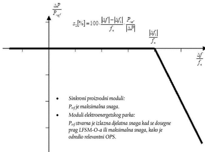
$P_{ref}$  referentna je djelatna snaga na koju se odnosi  $\Delta P$  i može biti različito određena za sinkrone proizvodne module i module elektroenergetskog parka.  $\Delta P$  je promjena izlazne djelatne snage proizvodnog modula.  $f_n$  je nazivna frekvencija (50 Hz) u mreži a  $\Delta f$  frekvencijsko odstupanje u mreži. Na nadfrekvencijama pri kojima je  $\Delta f$  iznad  $\Delta f_1$ , proizvodni modul mora osigurati smanjenje izlazne djelatne snage u skladu sa statizmom  $S_2$ .
