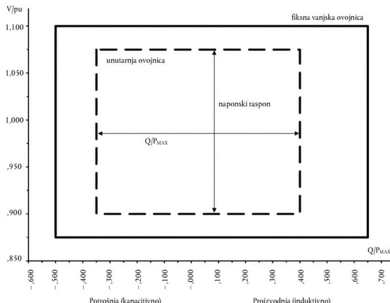
Dijagramom se prikazuju granice karakteristike  $U-Q/P_{max}$  ovisno o odnosu napona na mjestu priključenja, izraženog omjerom njegove stvarne vrijednosti i njegove referentne vrijednosti od 1 pu, i omjera jalove snage ( $Q$ ) i maksimalne snage ( $P_{max}$ ). Položaj, veličina i oblik unutarnje ovojnici su okvirni.
