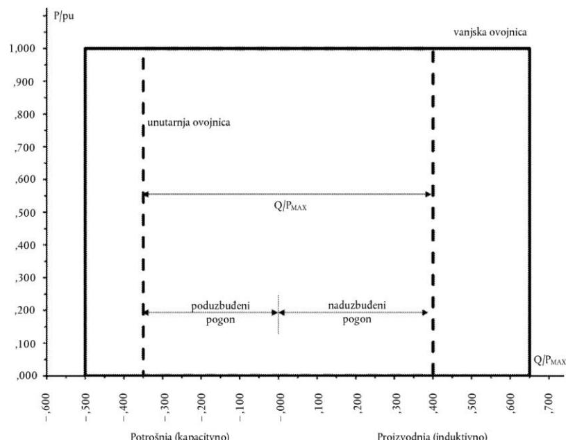
Dijagramom se prikazuju granice karakteristike  $P-Q/P_{max}$  na mjestu priključenja ovisno o odnosu djelatne snage, izražene omjerom njezine stvarne vrijednosti i relativne maksimalne snage u pu, i omjera jalove snage ( $Q$ ) i maksimalne snage ( $P_{max}$ ). Položaj, veličina i oblik unutarnje ovojnici su okvirni.
