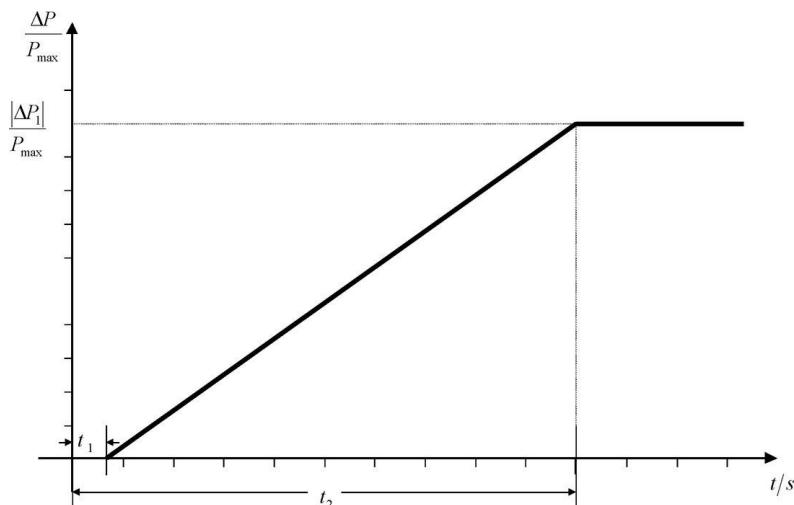
$P_{max}$  maksimalna je snaga na koju se odnosi  $\Delta P$ .  $\Delta P$  je promjena izlazne djelatne snage proizvodnog modula. Proizvodni modul mora osigurati izlaznu djelatnu snagu  $\Delta P$  do točke  $\Delta P_1$  u skladu s vremenima  $t_1$  i  $t_2$ , pri čemu vrijednosti  $\Delta P_1$ ,  $t_1$  i  $t_2$  određuju nadležni OPS u skladu s tablicom 5. Vrijednost  $t_1$  početno je kašnjenje, a  $t_2$  vrijeme za punu aktivaciju;
