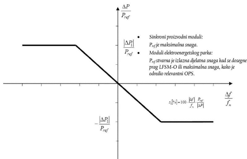
$P_{ref}$  referentna je djelatna snaga na koju se odnosi  $\Delta P$ .  $\Delta P$  je promjena izlazne djelatne snage proizvodnog modula.  $f_n$  je nazivna frekvencija (50 Hz) u mreži a  $\Delta f$  frekvencijsko odstupanje u mreži.
